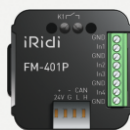
FM-401P Малогабаритный модуль ввода-вывода на 4 входа и 1 реле (16 A, 230 В)
