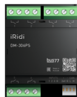
DM-306PS Релейный модуль для светодиодных ламп: 6 каналов реле на 16 A с симисторами, 3 дискретных входа
