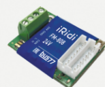
FM-808 24V Малогабаритный модуль ввода-вывода на 8 входов и 8 выходов
